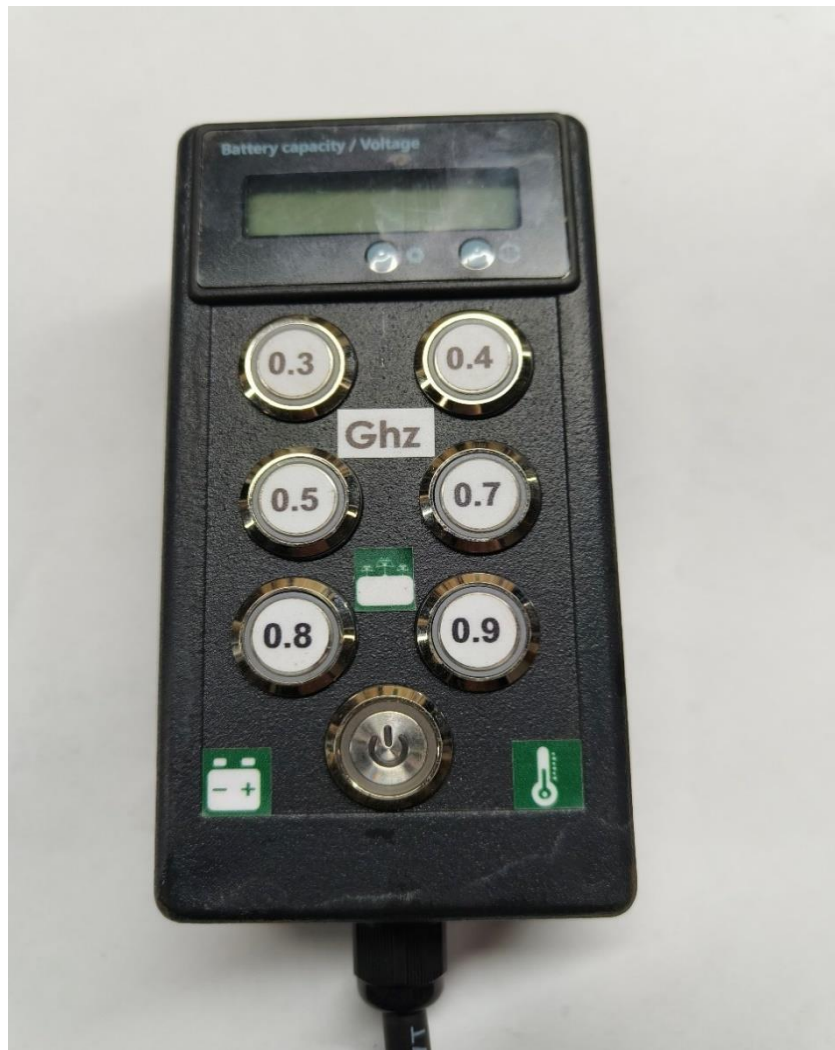
Рис.5. Пульт запуску комплексу РЕБ та керування частотами
